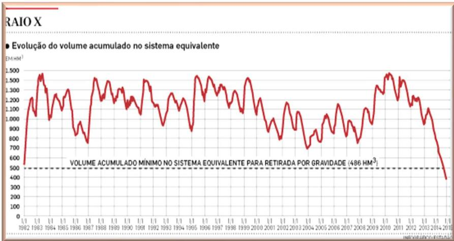
que separa o volume “vivo”, que pode ser retirado sem uso de bombas (entre 1.460 e 486) e o volume “morto” (entre 486 e 0), que só pode ser retirado por bombeamento.
